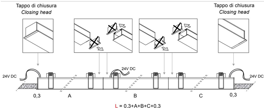
A B C = Lunghezza delle lampade senza tappi di chiusura. Lamps length without closing heads.
